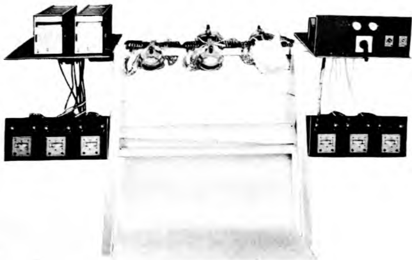
31-2. ábra. A KU 534 F7 n 1 típusú motorok élettartam-vizsgálata a vezérléssel együtt
