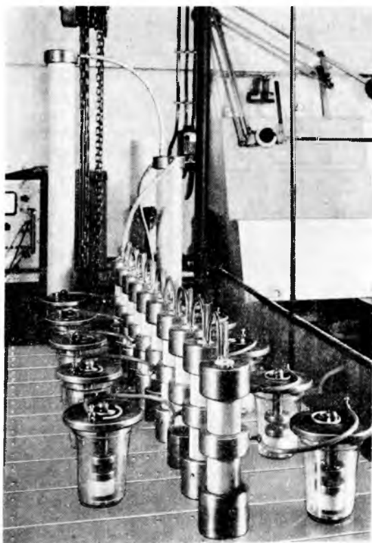
32-6. ábra. A treeing lappangási idejének mérésére szolgáló berendezés nagyfeszültségű része
