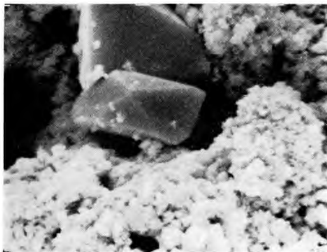
14-1. ábra. Pozitív aktív anyag elektronmikroszkópos felvétele 5000-szeres nagyításban, 50%-os kisütés után
